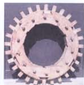
図1(上写真) 榎、樫などの堅い木で作られた水車の歯車
